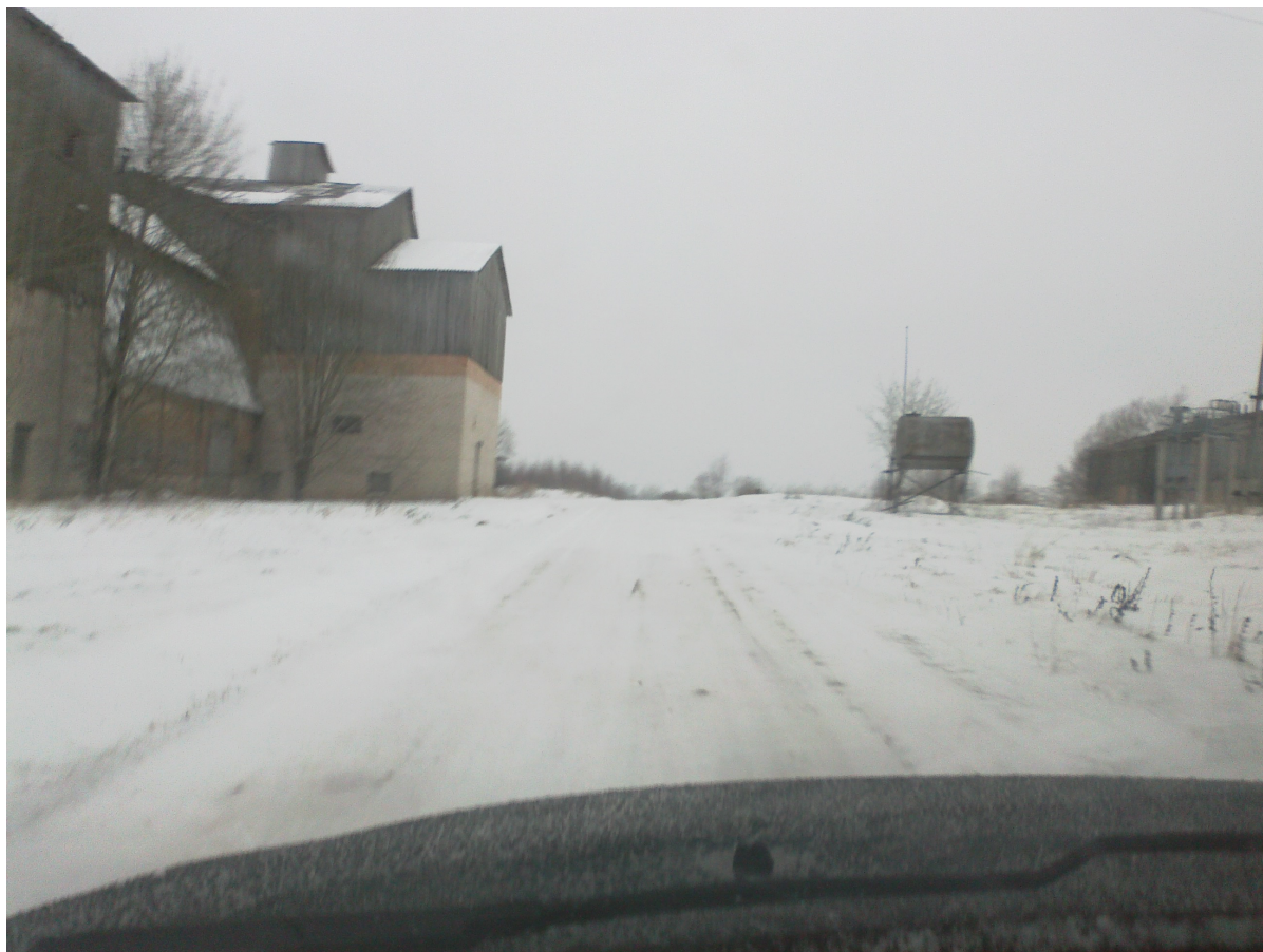
Attēls (pk 1+10) – ceļa segums zaudējis šķērskritumu, ir vienā līmenī ar apkārtējo reljefu, jāizveido jauni sāngrāvji.
